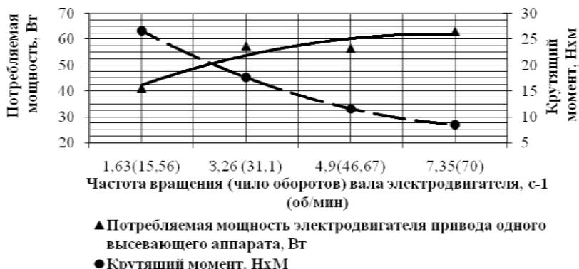
Рисунок 2 – Графики потребляемой мощности электродвигателя и крутящего момента в зависимости от частоты вращения вала
